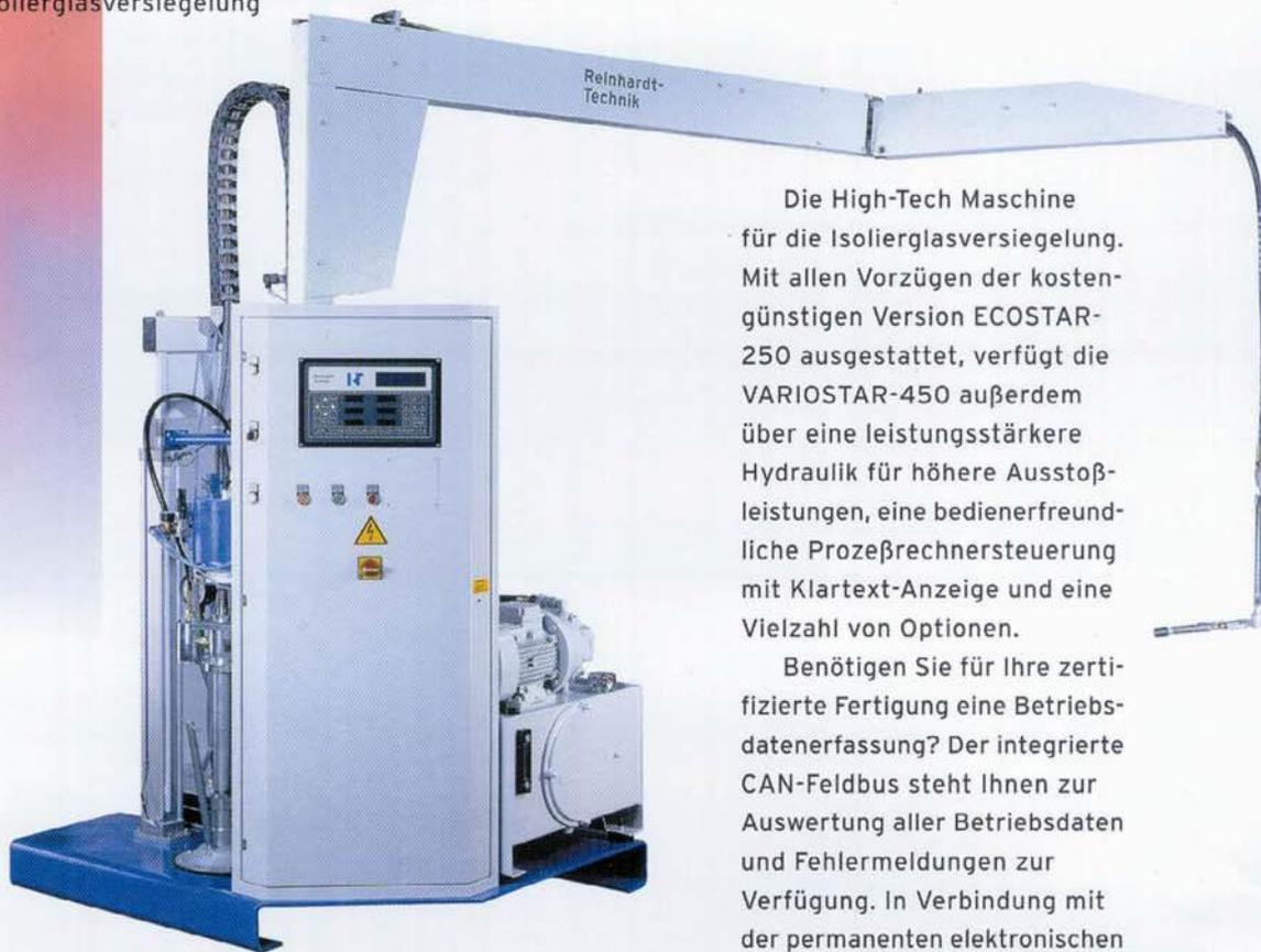
Die High-Tech Maschine für die Isolierglasversiegelung. Mit allen Vorzügen der kostengünstigen Version ECOSTAR-250 ausgestattet, verfügt die VARIOSTAR-450 außerdem über eine leistungsstärkere Hydraulik für höhere Ausstoßleistungen, eine bedienerfreundliche Prozeßrechnersteuerung mit Klartext-Anzeige und eine Vielzahl von Optionen.
